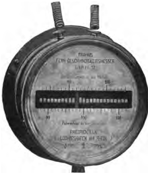
Abb. 478. Frequenzmesser von Friedr. Lux.
